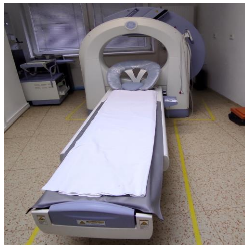
Obr. 22 Polovodičová kardiogamakamera „Discovery CZT 530c“ f. GE (ÚVN Ružomberok FN)
