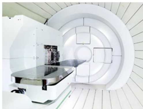
Obrázok 7, 8 Schematický náčrt protónového gántry (hore) a jeho reálna podoba (dole) v Proton Medical Research Center, Tsukuba, Japonsko. (9)
