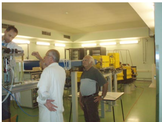
Obrázok 6 Protónový synchrotrón v Ústrednej vojenskej nemocnici v Ružomberku počas fyzikálnych meraní - testovanie parametrov protónového zväzku.
