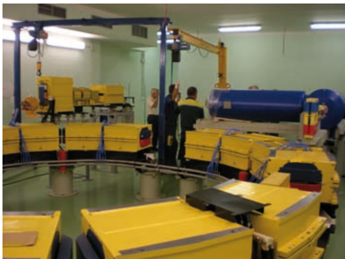
Obrázok 5 Urýchľovač protónov (synchrotrón) počas montáže v novej budove PTK v ÚVN v Ružomberku
