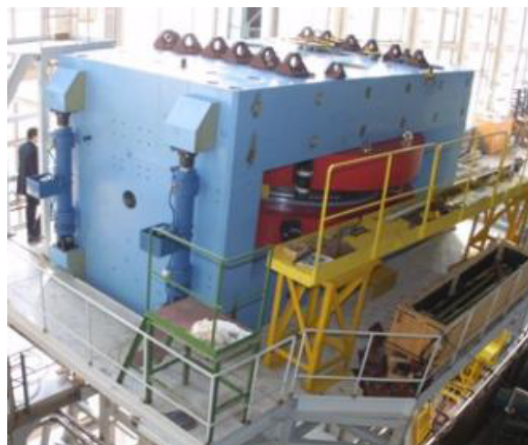
Obr. 12 Cyklotrón DC-72 s maximálnou energiou protónov 72 MeV vyvinutý v Dubne pre Cyklotrónové Centrum Slovenskej republiky. Cyklotrón sa bude okrem iného využívať aj na protónovú terapiu oka.
