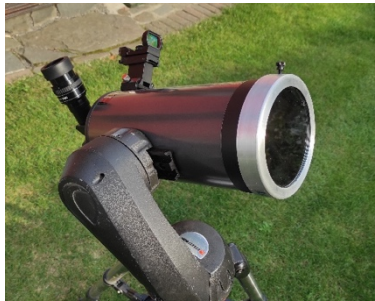
Obrázek 3 – Astronomický ďalekohľad Maksutov-Cassegrain, priemer zrcadla 127mm s montážou a slnečným filtrom. (Foto autor)
